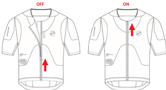
Figure 8 : Le système se met en marche lorsque le zip d'activation (2) est fermé
